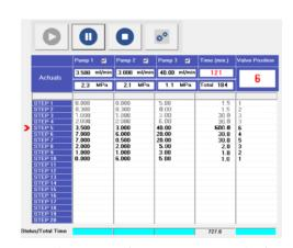
3台迄のポンプと自動バルブをWindows PCでプログラミング送液シンプルな画面で分かりやすく簡単に精密フローケミストリーに応用微量/大流量,接液部材質,バルブポート数など,組合せ自在
