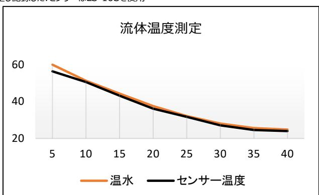
\* センサー入口部チューブは室温の影響を受けやすいため、極力短く設置してください。
